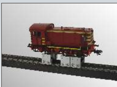
Universal-Rollenprüfstand Spur N und H0e 4ständig (Art. Nr. B-31200)
